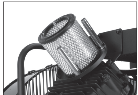
Figura 14 - Filtro de aire
