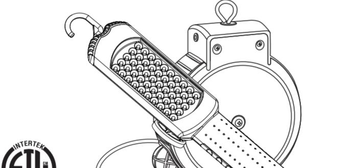
3. Place hanger bracket (B) inside U-shaped bracket (A) formé en U en alignant le petit trou dans le crochet.
