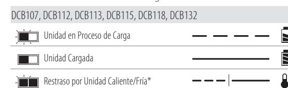
**\*DCB107, DCB112, DCB113, DCB115, DCB118, DCB132:** La luz roja continuará parpadeando, pero una luz indicadora amarilla estará iluminada durante esta operación. Una vez que la batería haya llegado a una temperatura apropiada, la luz amarilla se apagará y el cargador continuará con el procedimiento de carga.
