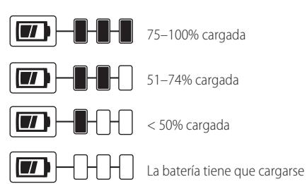
Para activar el indicador de carga, presione y sostenga el botón del indicador. Se iluminará una combinación de las tres luces LED verdes, que indicará el nivel de carga que queda. Cuando el nivel de carga está por debajo del nivel útil, el indicador no se iluminará, y la batería deberá recargarse.
